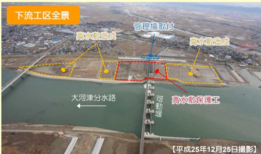
下流工区の可動堰右岸高水敷部では、平成24年度から実施してきた高水敷の造成工事を継続して実施中です。造成に使う土砂は、分水路下流の渡部地区から採取し、ダンプトラックで運搬しているほか、他機関工事から発生した残土等を活用しています。あわせて、可動堰管理橋上下流部で高水敷保護工の覆土ブロックの設置工事を進めています。
