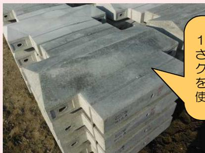
1 m2当たりの重さが350kgのコンクリートブロックを鉄筋でつないで使用しています。
