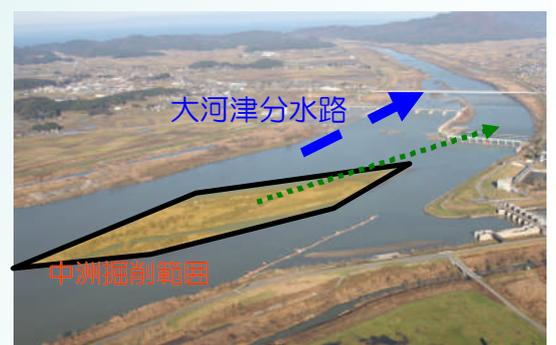
(写真右) 上流側の中洲は洪水時に水の流れを阻害するため掘削除去し、発生した土を高水敷造成(II)に利用します。
