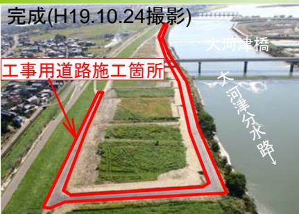
この工事用道路は、今後右岸側の工事を行う際に使用します。(延長約1,350m、幅6m)
