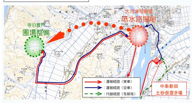
先月号でご紹介したように、可動堰改築事業では事業の後半に予定している右岸側の高水敷 造成に備え、中条新田地先へ掘削土砂の仮置きをはじめましたが、その他にも地域の社会資本 整備に貢献するよう近隣で行われている圃場整備事業などに運搬し、有効利用を行っています。 現在は、寺泊夏戸地先で長岡地域振興局が計画している圃場整備事業実施箇所などに搬出し ています(上の図をご参照下さい)。なお、運搬期間は11月頃までの予定です。
