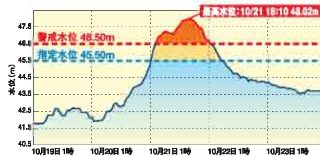
平成16年10月19～23日の水位状況 [小千谷]
