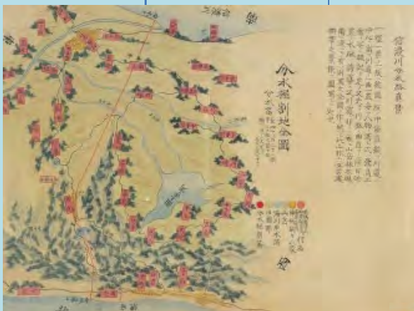
第1期工事における分水路の計画線。大川津から須走海岸までの掘削延長は4,832間(約8.7km)と記されています。
