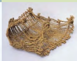
ホソ(左)とモッコ(上)。ホソ等で土を掘り、モッコの中に土を入れて2人で担いで運搬しました。山地部は硬くて掘りにくく、人海戦術による当時の開削技術では困難を極めました。
