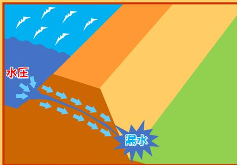
水位が高い状態が続くと水圧により漏水が発生し、最悪の場合、堤防が決壊する事があります
