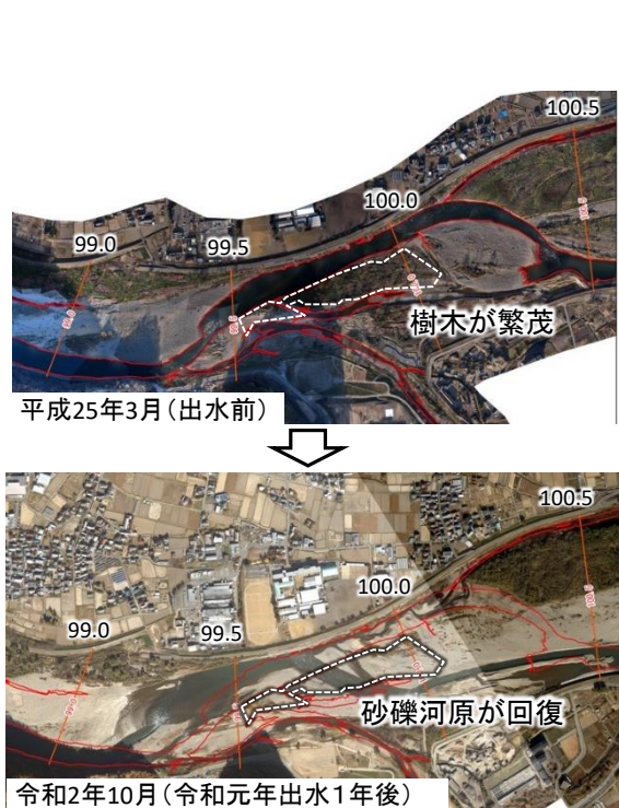
図2-①-8 出水後の地形変化で整備が不要になった箇所
