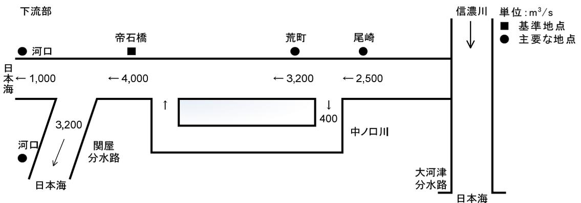
図 8 下流部計画高水流量図 (単位:m<sup>3</sup>/s)
