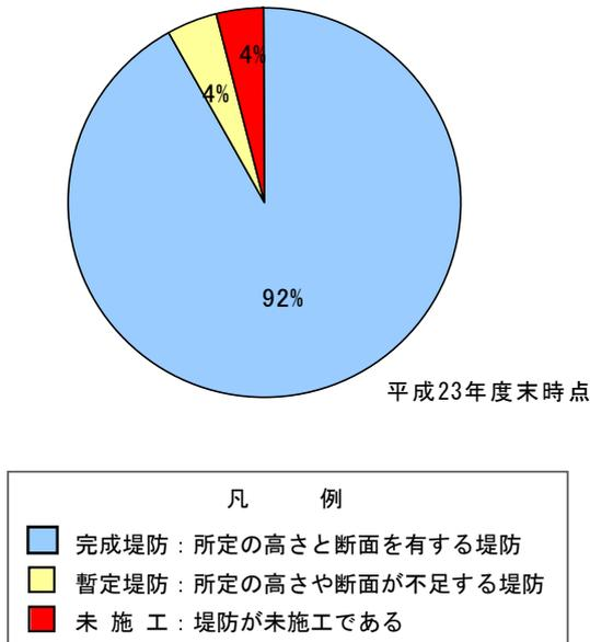
図 11 下流部の堤防整備状況
