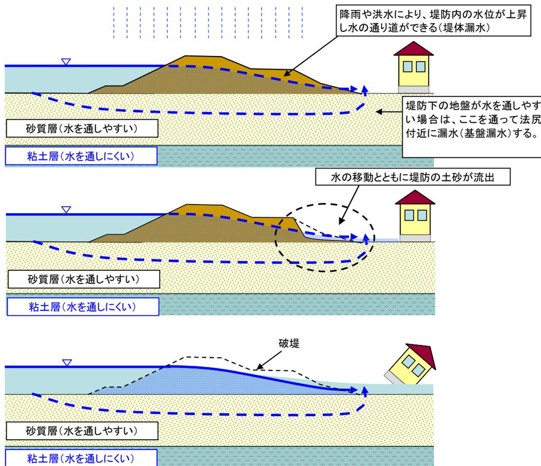
図 20 浸透による堤防の決壊メカニズム
