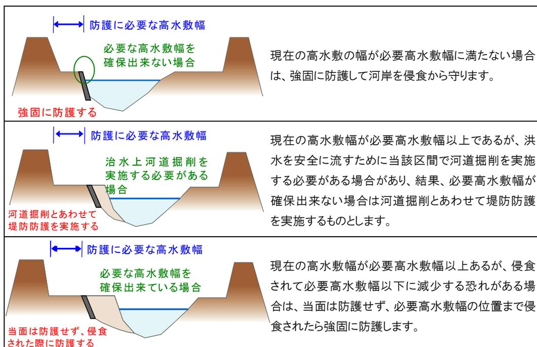
図 40 高水敷幅による堤防防護の考え方
