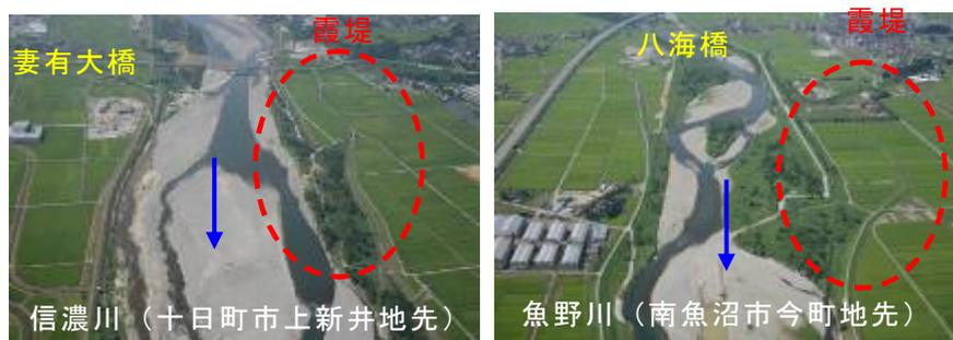
図 19 信濃川・魚野川の霞堤
