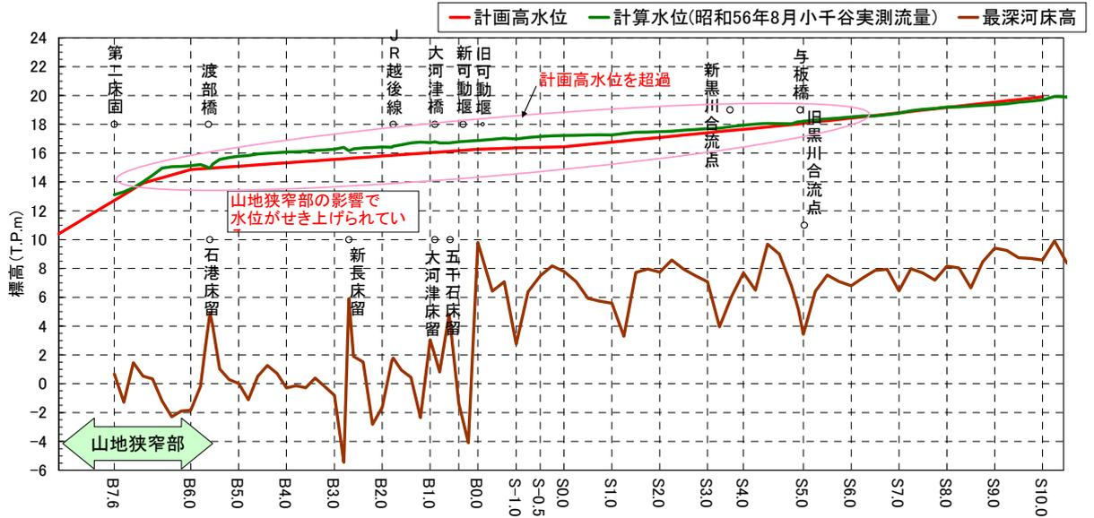
図 13 昭和 56 年 8 月洪水水位縦断面図
