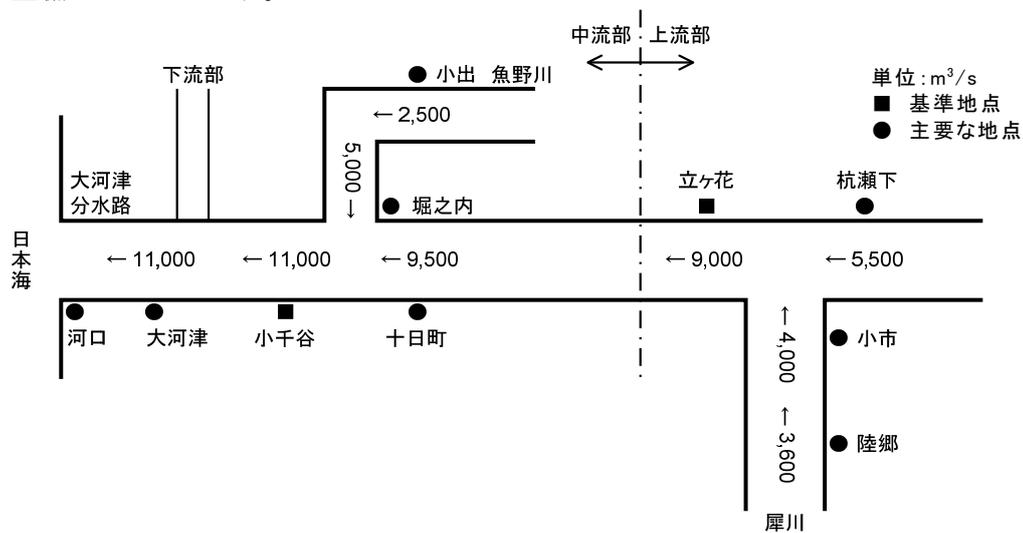
図 7 上流部・中流部計画高水流量図 (単位:m<sup>3</sup>/s)
