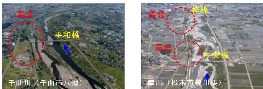
写真 6 千曲川・犀川の霞堤 信濃川・魚野川の霞堤
