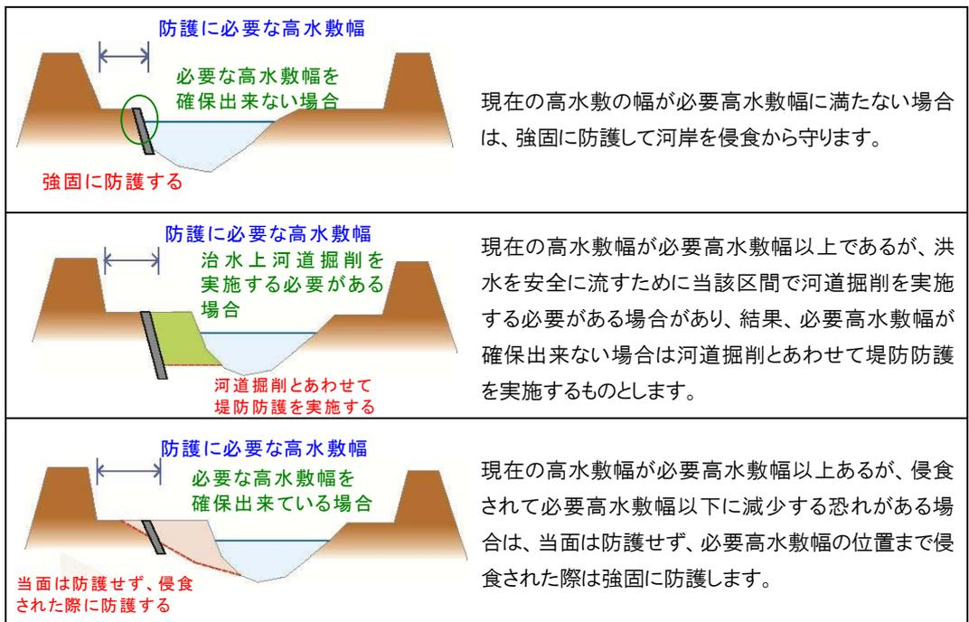
図 47 高水敷幅による堤防防護の考え方
