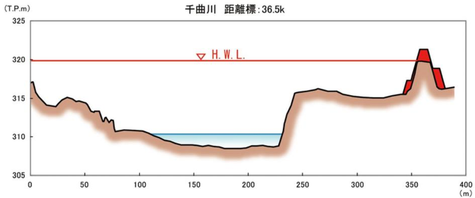
図 37 堤防整備断面のイメージ図(上流部)
