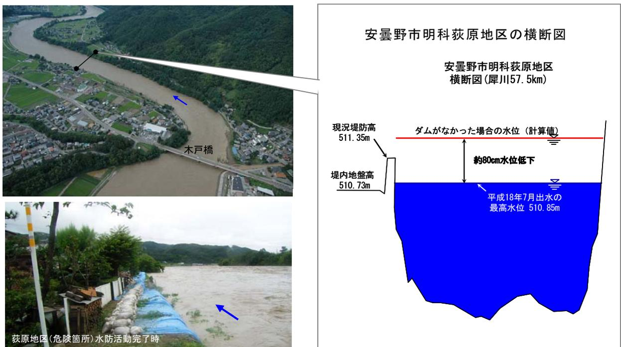
図15 平成18年7月洪水時の利水ダム群連携操作による効果の概要
