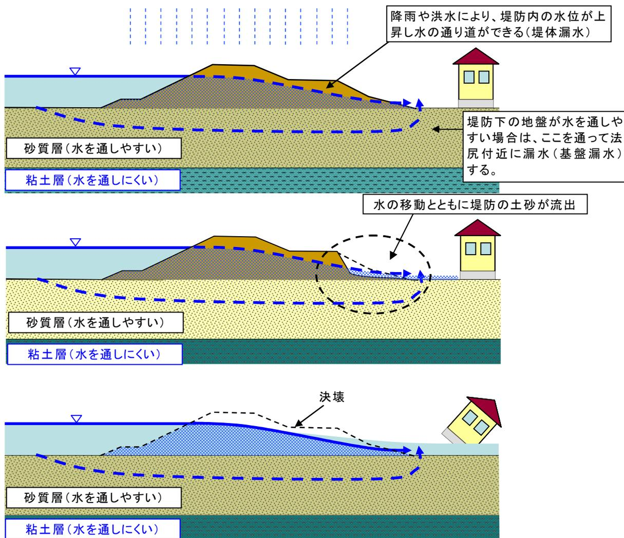
図 17 浸透による堤防の決壊メカニズム
