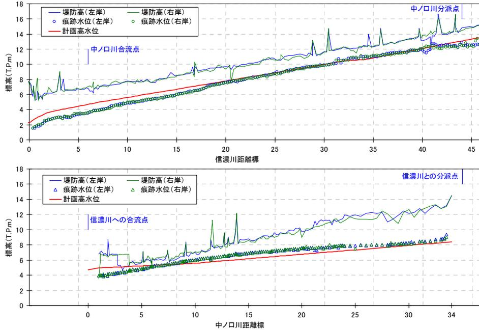
図 13 平成23年7月洪水痕跡水位縦断面図
