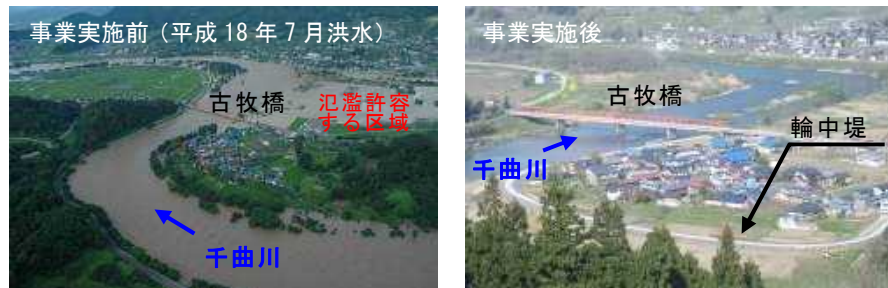
写真 5 土地利用一体型水防災事業で輪中堤を整備した中野市古牧地区(千曲川)
