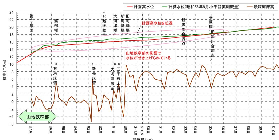
図 12 昭和 56 年 8 月洪水水位縦断図(河口～信濃川 10.0km)
