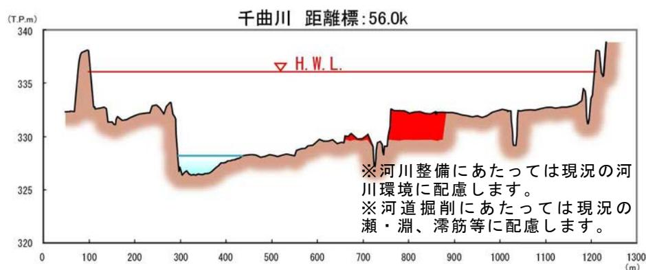
図 40 河道掘削断面のイメージ図(上流部)
