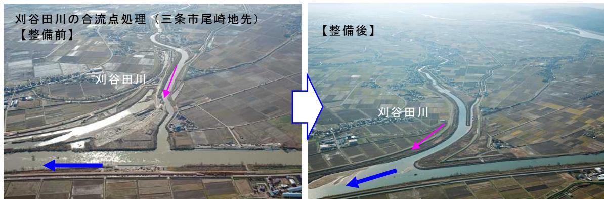
写真 56 合流点処理の実施例
