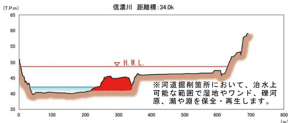
図 41 河道掘削断面のイメージ図(中流部)
