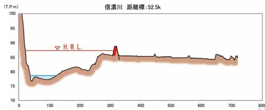
図 38 堤防整備断面のイメージ図(中流部)
