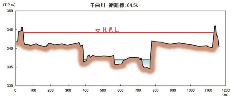
図 37 堤防整備断面のイメージ図(上流部)
