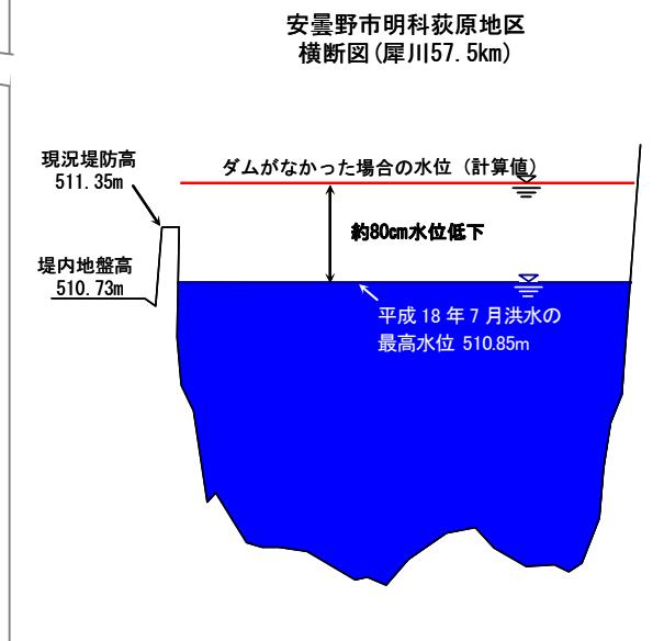
図 15 平成 18 年 7 月洪水時の利水ダム群連携操作による効果の概要
