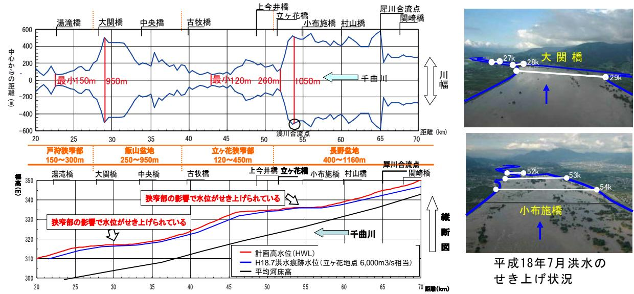
図 11 川幅と水位縦断図
