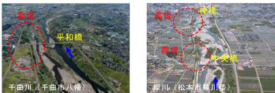
写真 6 千曲川・犀川の震堤信濃川・魚野川の震堤
