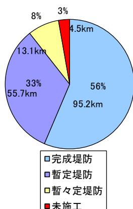
図 9 中流部の堤防整備状況
