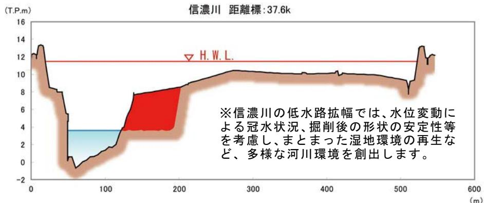
図 42 河道掘削断面のイメージ図(下流部)
