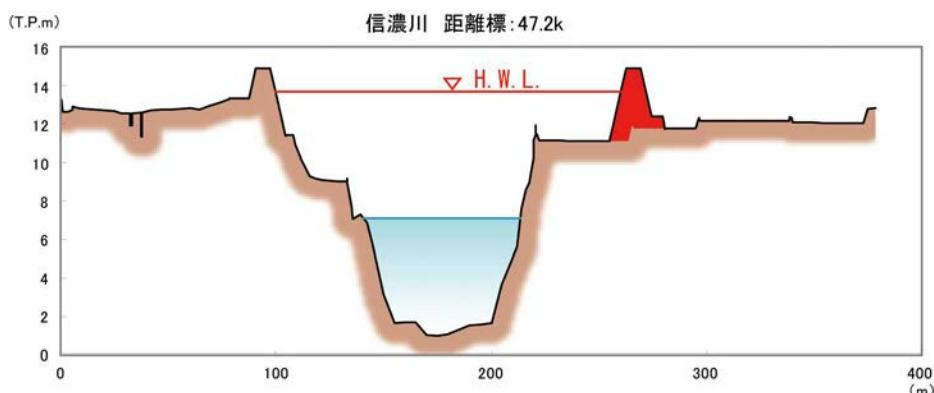
図 39 堤防整備断面のイメージ図(下流部)
