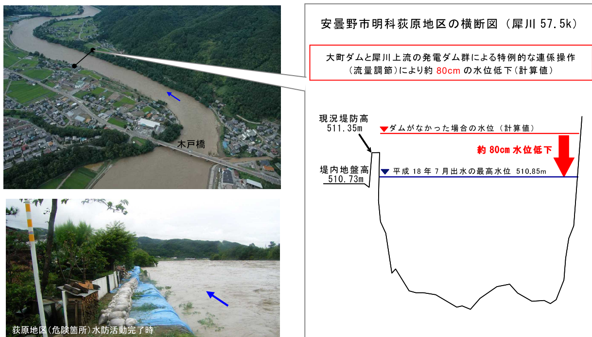
図 17 平成 18 年 7 月洪水時の利水ダム群連携操作による効果の概要
