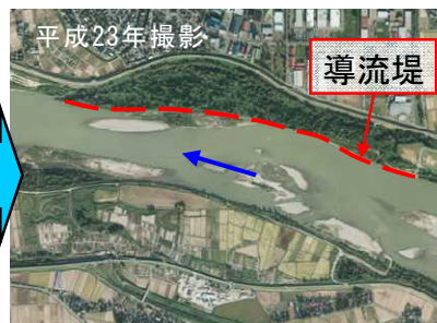
平成23年撮影 導流堤の施工により低水路が安定
