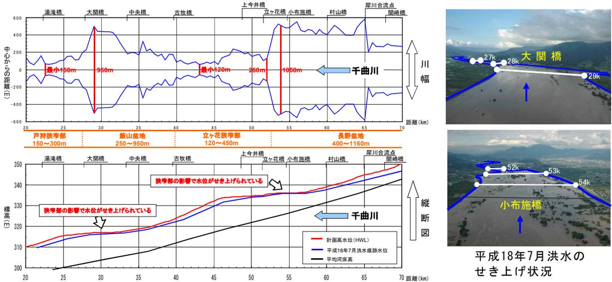
図 11 川幅と水位縦断面図
