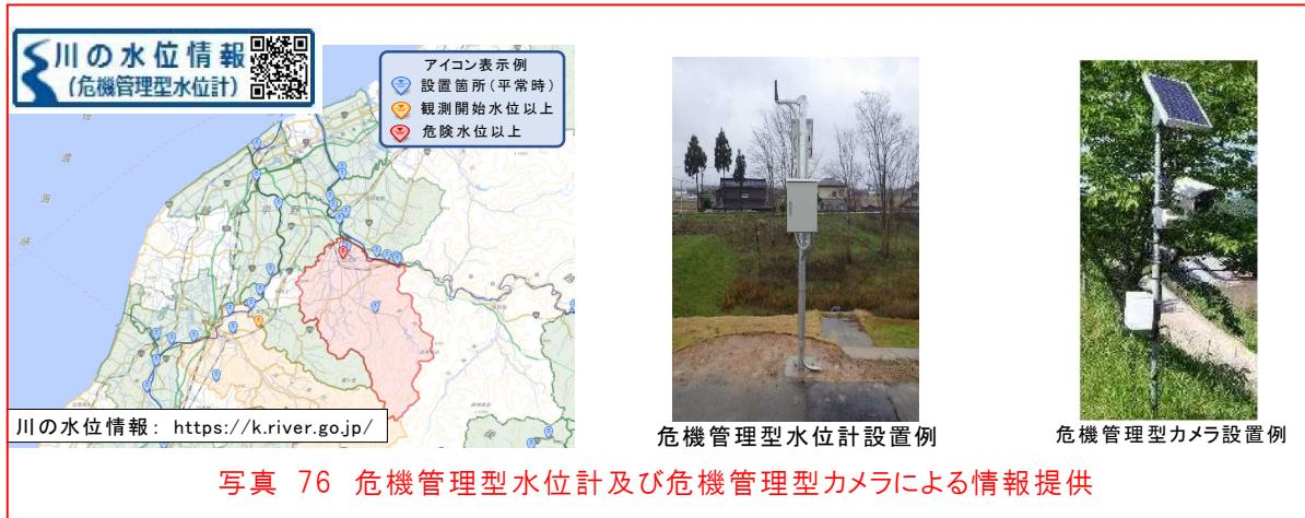
写真 76 危機管理型水位計及び危機管理型カメラによる情報提供
