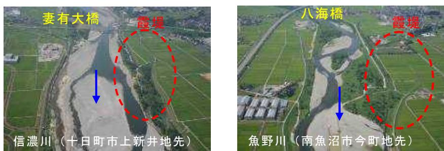
写真 7 信濃川・魚野川の震堤
