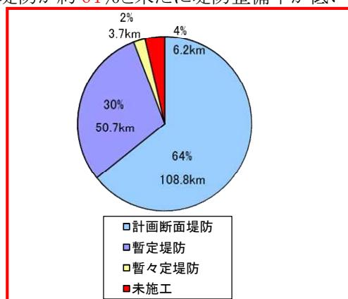
図 9 中流部の堤防整備状況
