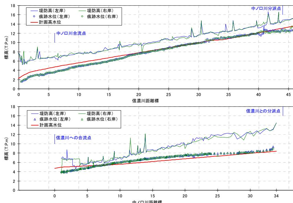
図13 平成23年7月洪水痕跡水位縦断図
