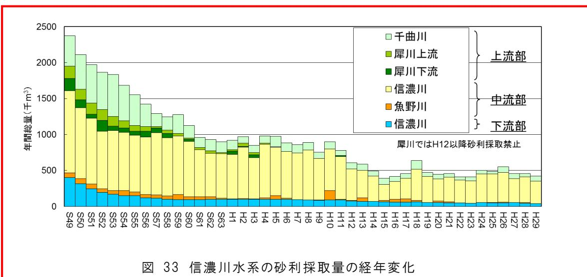
図 33 信濃川水系の砂利採取量の経年変化
