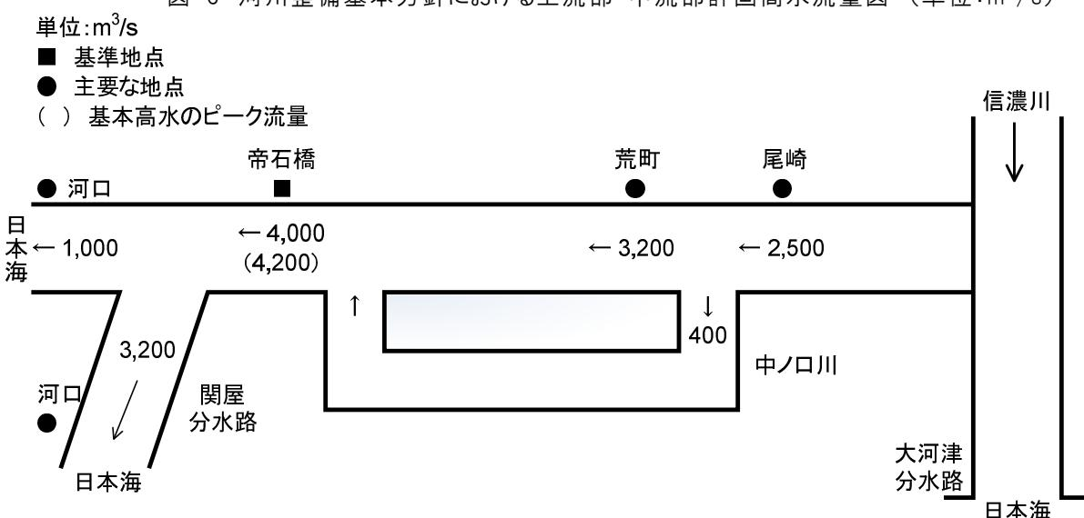
図 7 河川整備基本方針における下流部計画高水流量図 (単位:m<sup>3</sup>/s)
