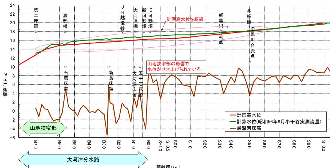
図 12 昭和 56 年 8 月洪水水位縦断図(河口～信濃川 10.0km)
