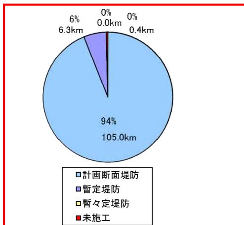
図 10 下流部の堤防整備状況
