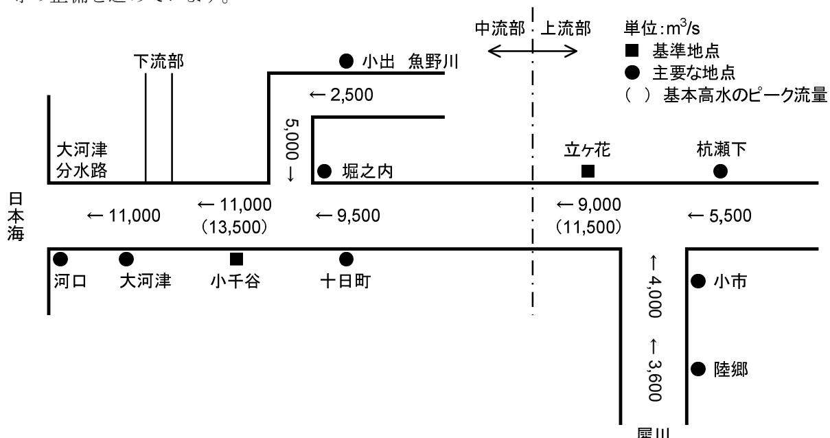
図 6 河川整備基本方針における上流部・中流部計画高水流量図 (単位:m<sup>3</sup>/s)
