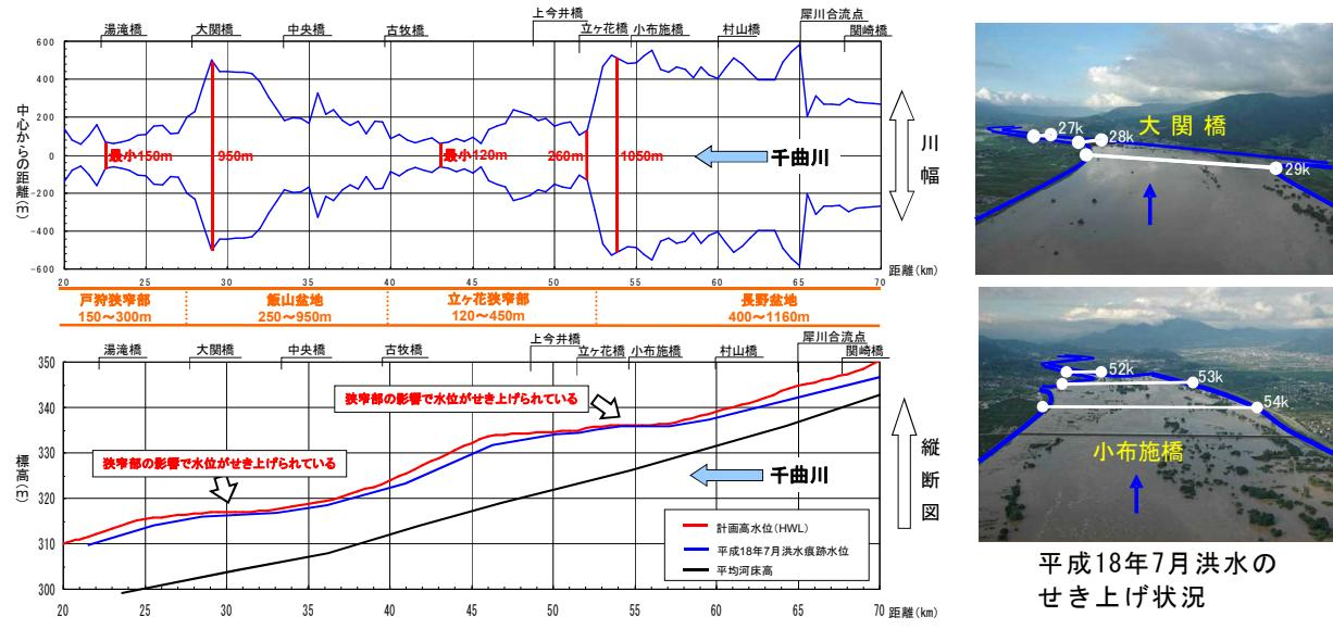
図 11 川幅と水位縦断図
