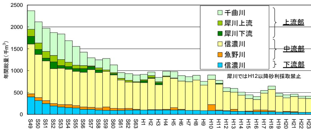
図 33 信濃川水系の砂利採取量の経年変化
