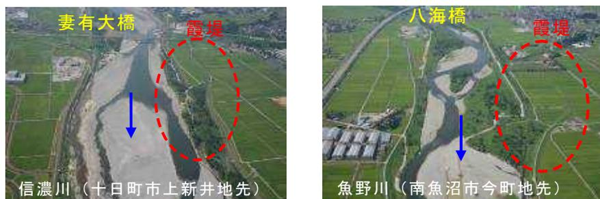
写真 7 信濃川・魚野川の霞堤
