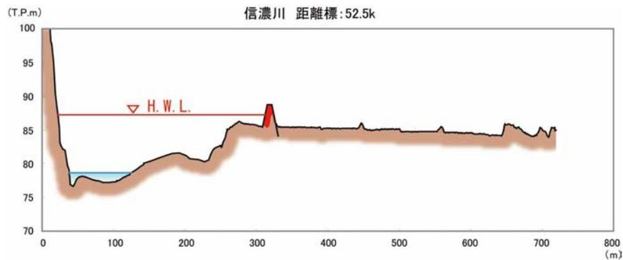
図 38 堤防整備断面のイメージ図(中流部)
