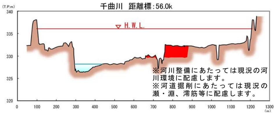
図 40 河道掘削断面のイメージ図(上流部)
