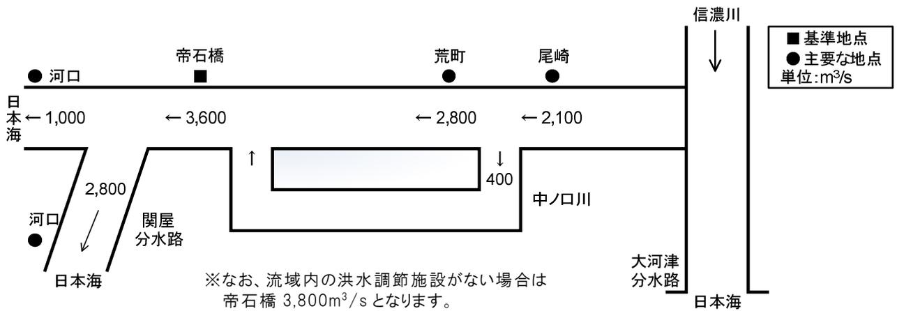
図 36 平成 23 年 7 月洪水と同規模の洪水(下流部)
