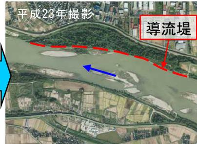
導流堤の施工により低水路が安定
