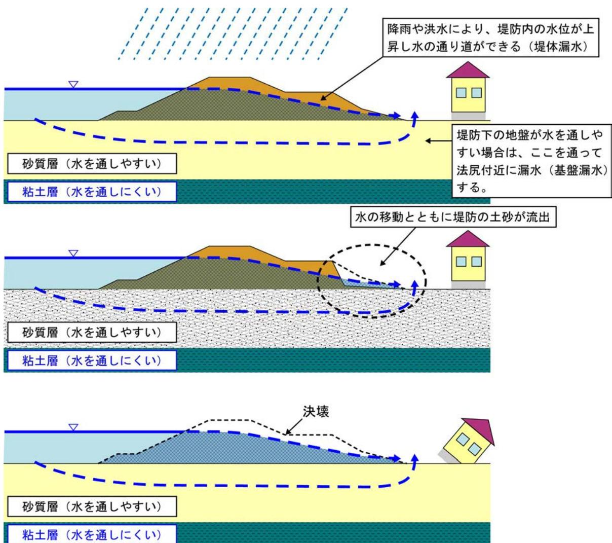
図 17 浸透による堤防の決壊メカニズム
