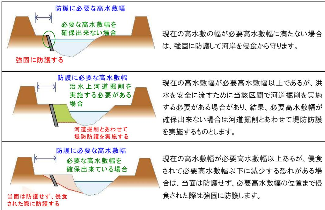
図 48 高水敷幅による堤防防護の考え方
