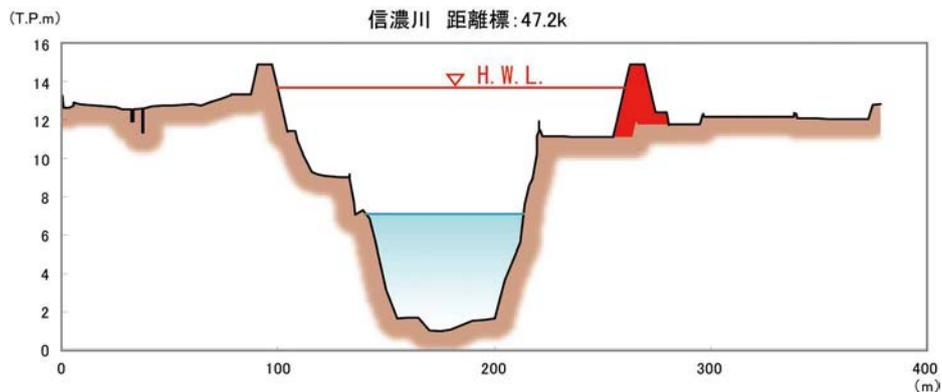
図 39 堤防整備断面のイメージ図(下流部)
