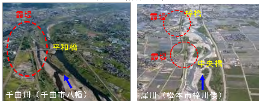
図 18 千曲川・犀川の霞堤
