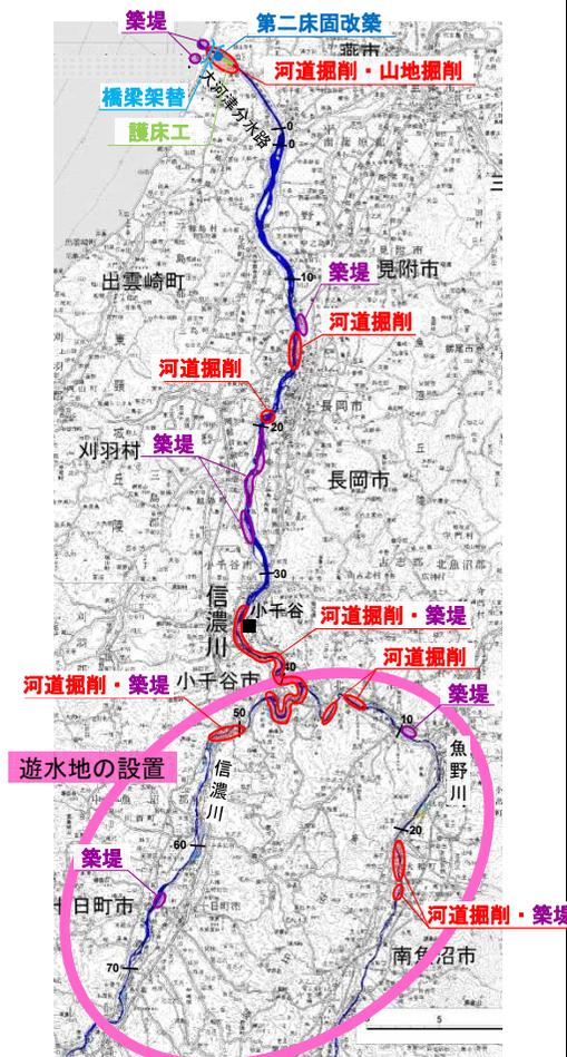
築堤 L=約17,600m 掘削工 V=約15,400千m<sup>3</sup>
