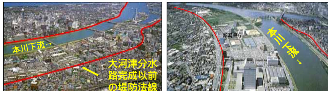
信濃川低水路工事による川幅の減少
