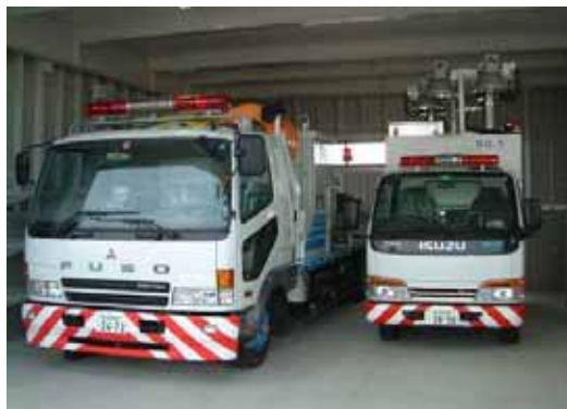
災害対策機械（排水ポンプ車、照明車）を配備
