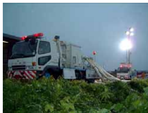
災害対策機械（排水ポンプ車、照明車）を配備
