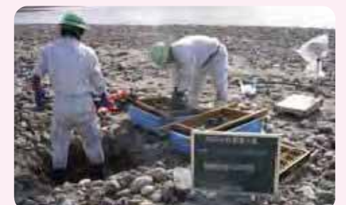
▲河川の調査実施状況(河床材料調査)
