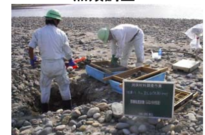
河床材料調査
