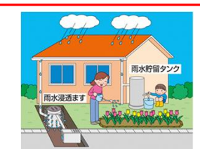
雨水浸透ます・雨水貯留タンク(新潟市)
