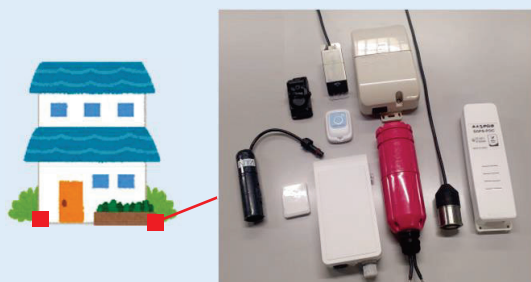
実証実験に用いている浸水センサ
