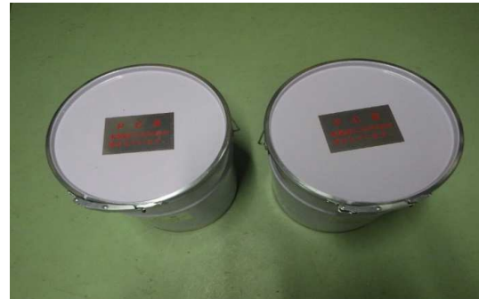
ペール缶にPCB安定器収納完了
