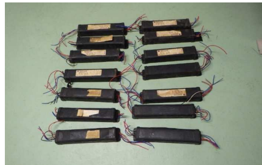
発生品 高濃度PCB安定器
