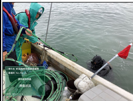
海上の水平(潜水)磁気探査状況
