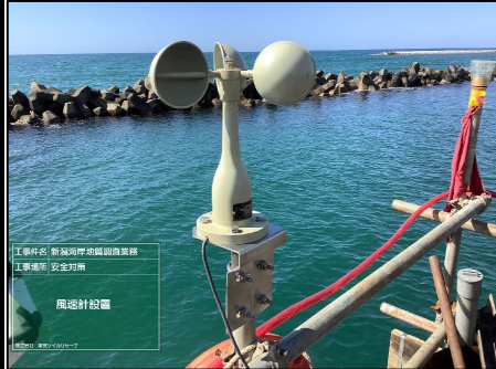
風速計、赤旗、標識灯設置
