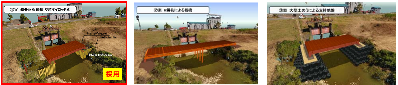
図-5：仮栈橋工法の検討
