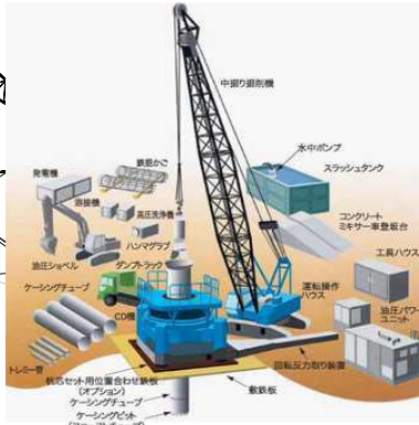
全周掘削機による障害物撤去
