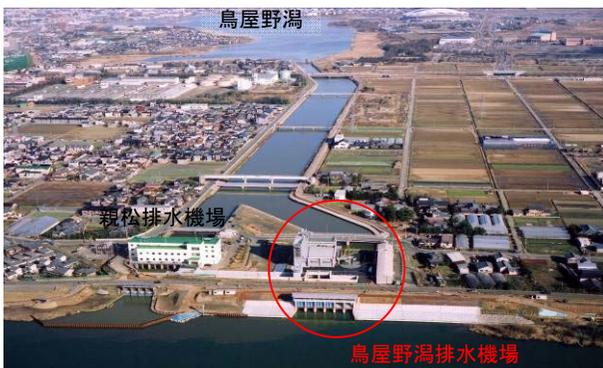
H23.7.29水害での鳥屋野潟排水機場の排水量・・・約6,540千m<sup>3</sup>
