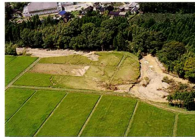
① 水衝部での洪水の溢水
