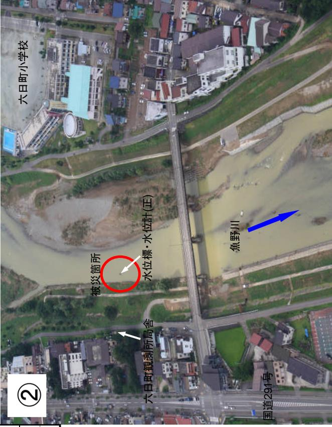
② 今出水の最高水位(D.H.W.L)は161.48m(T.P.換算値)と、H.W.L=161.78mより0.30m下がりの出水規模であった。
