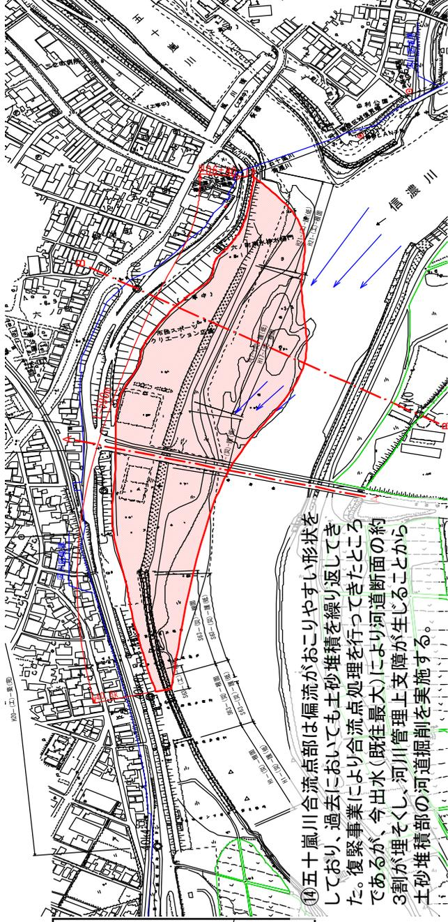
⑭五十嵐川合流点は偏流がおこりやすい形状をしており、過去においても土砂堆積を繰り返してきた。復旧事業により合流点処理を行ってきたところであるが、今出水（既往最大）により河道断面の約3割が埋そくし、河川管理上支障が生じることから土砂堆積部の河道掘削を実施する。
