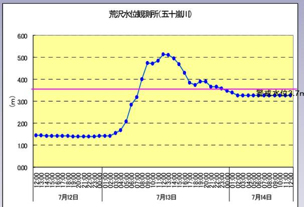
支川の出水状況(五十嵐川合流点/13日PM)
