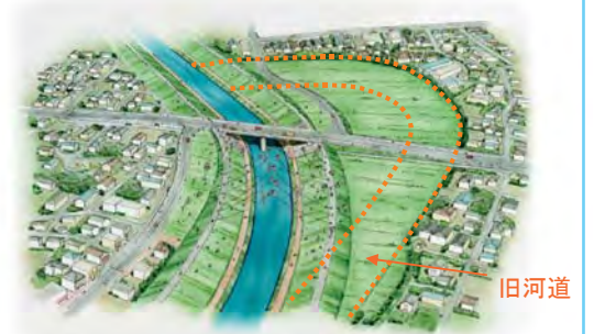
屈曲部の是正(刈谷田川ショートカット)
