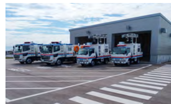
天野河川防災ステーション 災害対策車輛（排水ポンプ車、照明車）
