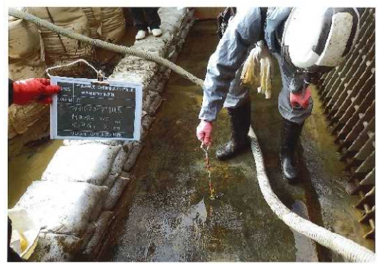
大島頭首工取水樋管での平張部空洞調査、函体基礎地盤緩み層調査
