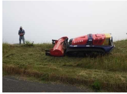
大型ラジコン除草
