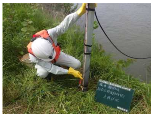
水位観測所 総合点検
