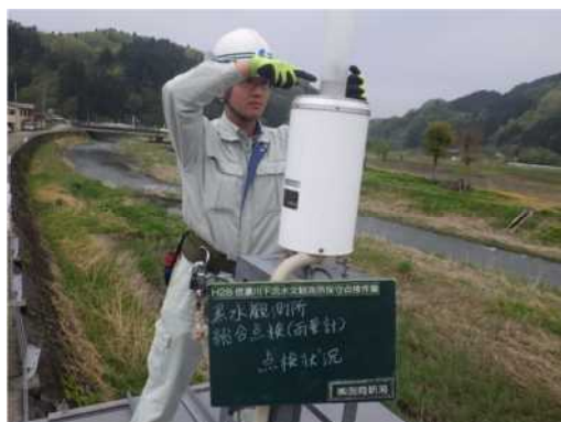
雨量観測所 総合点検
