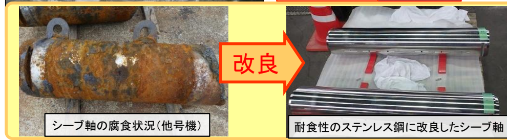
新潟大堰 主ゲート ワイヤロープシーブ(滑車)の交換
