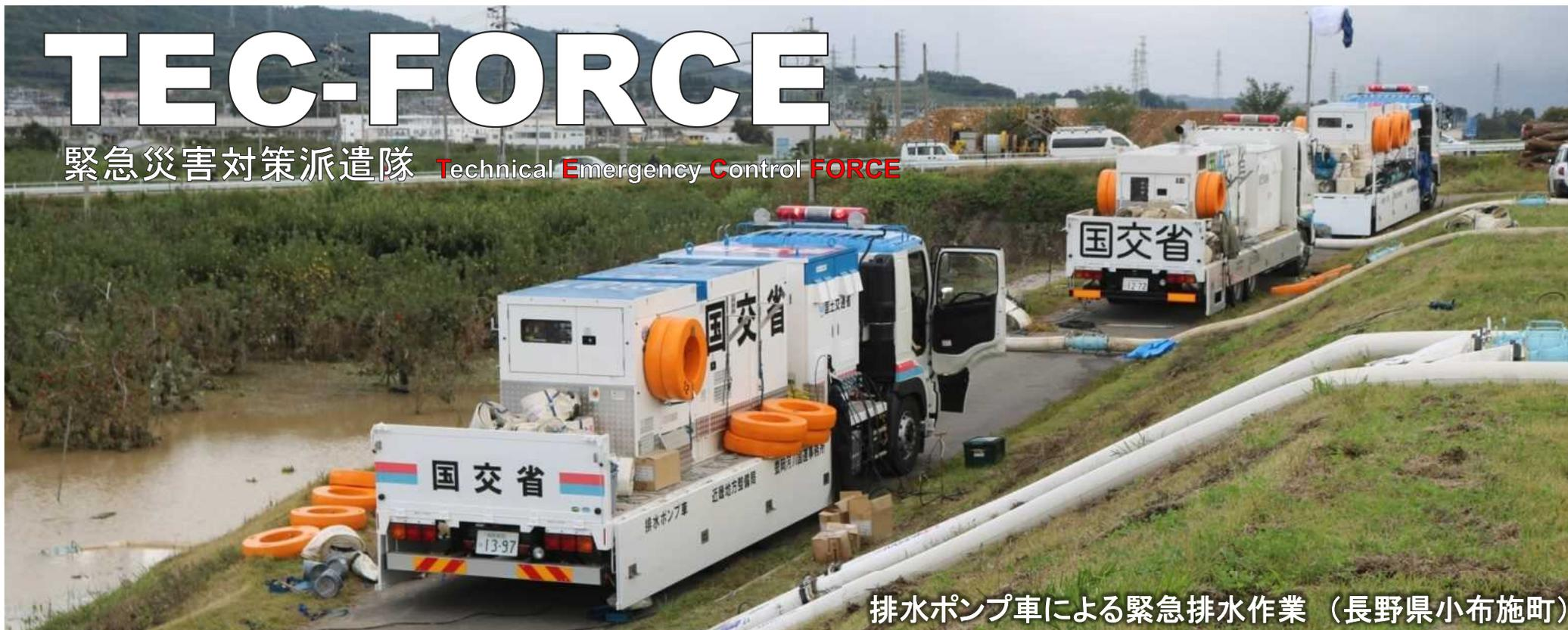
排水ポンプ車による緊急排水作業（長野県小布施町）
