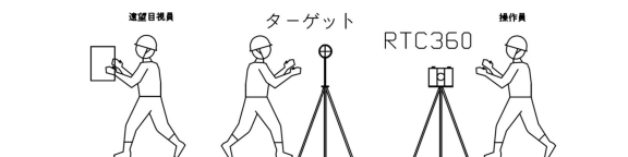
図 2. 詳細調査（遠望目視調査および三次元断面計測）
