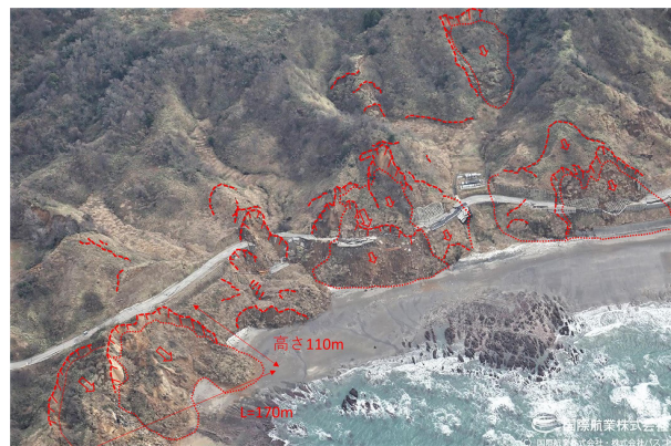
写真1. 地すべり・斜面崩壊（大川浜地区）
