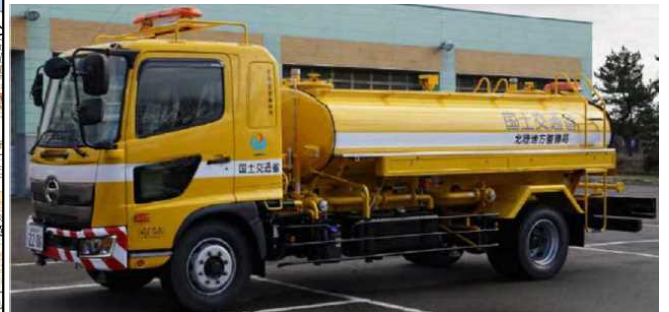
給水車(6,300リットル・給水口4個)
