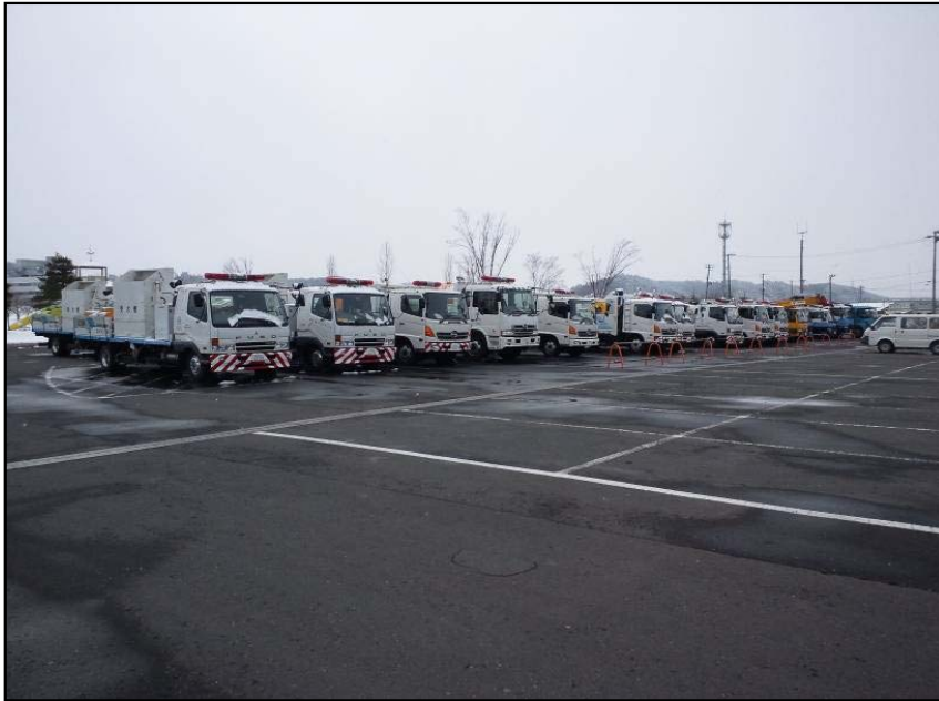
災害対策用機械(現地派遣状況) 岩手河川国道事務所一関出張所に配備された 排水ポンプ車、照明車
