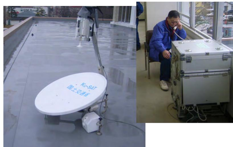
3/16 衛星小型画像伝送装置(KU-SAT)の利用(名取市役所)
