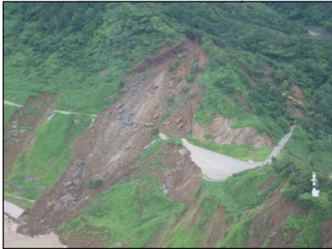
砂防 柏崎市米山(よねやま) がけ崩れ H=90m W=60m
