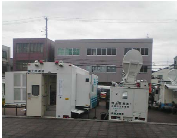
7月16日に設置した災害対策現地支援センター(柏崎市役所前)と北陸地方整備局の間に、衛星通信車による通信回線を確保
