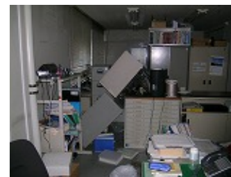
事務室家具の転倒
