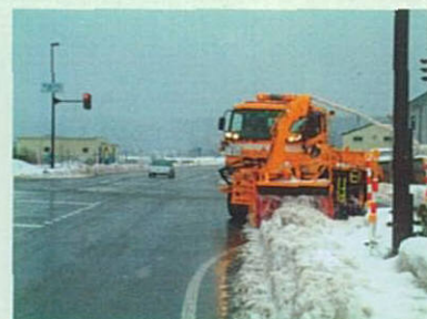
ランプ・交差点部の除雪 (サイドスライド+アングリング)
