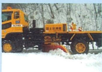
路面整正併用作業
