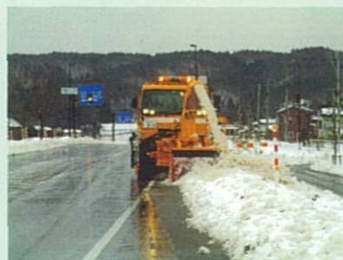
直線・バス停部の除雪 (サイドスライドのみ)
