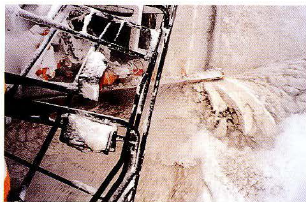
トラック・グレーダ装置部から出る飛雪状況
